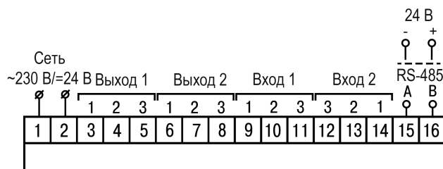
Рисунок 5.7 – Общая схема подключения 2TRM1–Н
